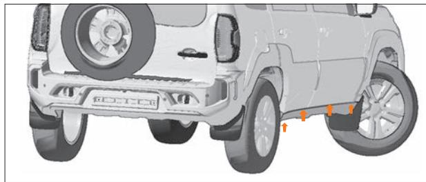
Рис. 89. Дренажные отверстия дверей и порогов
