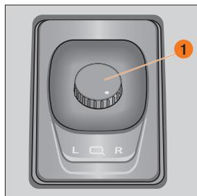
**Рис. 28. Блок управления наружными зеркалами**
