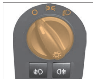
Рис. 14а. Переключатель наружного освещения
