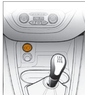
Рис. 6в. USB-разъем для подключения USB-накопителя (в варианном исполнении)
