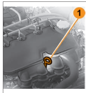
Рис. 4. Проверка уровня масла в картере двигателя
