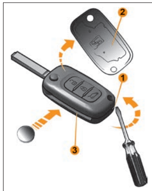
Рис. 10. Замена элемента питания пульта дистанционного управления
