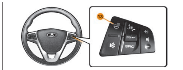
Рис. 2в. Кнопка включения подогрева рулевого колеса (в варианном исполнении)
